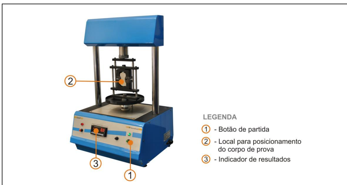
Figura 2 – Foto ilustrativa de uma máquina de ensaios para ensaio de resistência à tração.
